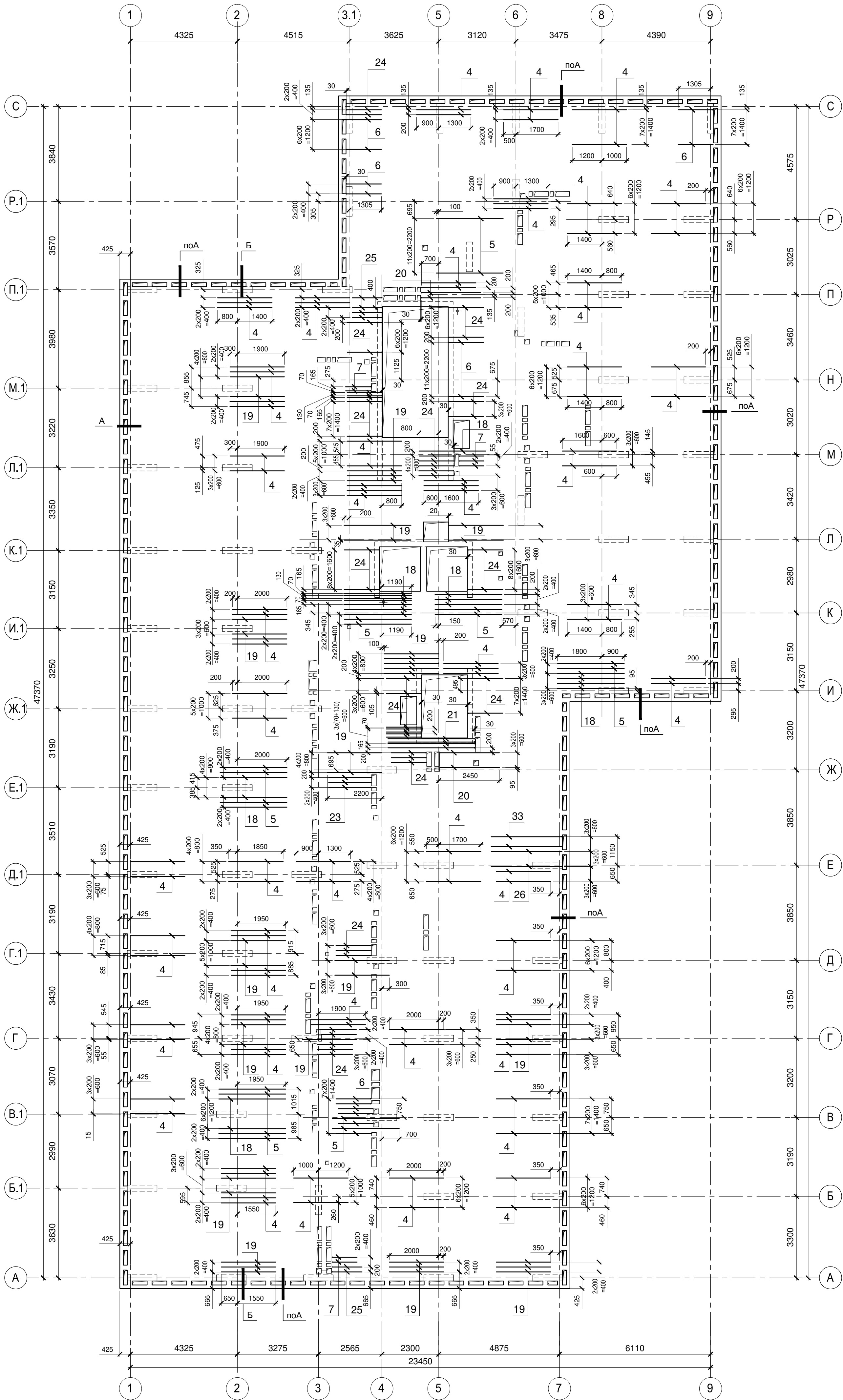
Узел расположения дополнительной арматуры с шагом 200 мм
